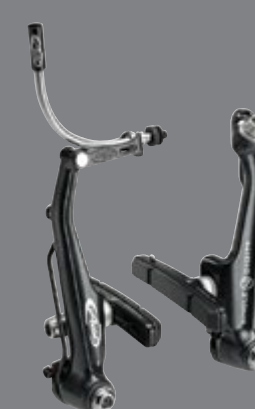
195203 AVID KOMPLET V KLEŠTA SINGLE DIGIT 7 (prednja+zadnja), hladno kovane ručice klešta, svi sitni delovi napravljeni od nerđajućeg čelika, linearne opruge, pakne sa promenljivim ulošcima.
