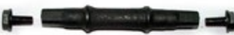
130409 OSOVINA SA ČETVRTASTIM ZAVRŠETKOM 5T B ENGLESKI NAVOJ ukupna dužina 128mm, leva strana 35mm, sredina 54mm, desna strana 39mm
