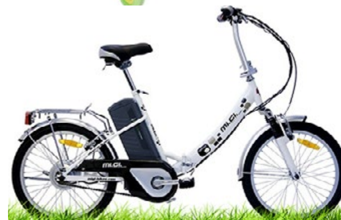
292010 BIKIKL EBIKE SPRINT ČELIČNI RAM TOČKOVI 20x1,75 ALU BATERIJA OLOVO 36V 18 A/h MAKSIMALNA TEŽINA VOZAČA 90kg BRUTO TEŽINA BIKIKLA 30kg MAKSIMALNA BRZINA 24km/h
