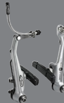
195210 AVID KOMPLET V KLEŠTA SINGLE DIGIT SL (prednja+zadnja), hladno kovane ručice klešta, aluminijumska centralna konzola, linearne opruge, pakne sa promenljivim ulošcima, titanijumski sitni delovi.
